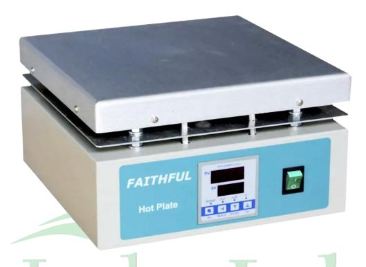
Placa caliente de aluminio, temperatura superficial uniforme. El calentamiento es rápido y uniforme, la potencia de calentamiento es ajustable sin escalas.
