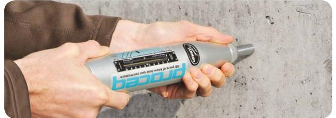
**Modelo N/L:** La referencia frente a la cual se miden todos los demás martillos de rebote y la base de cualquier norma internacional de martillo de rebote. Disponible con diferentes energías de impacto para permitirle a los clientes ensayos en una gran variedad de materiales y tipos de estructura.
