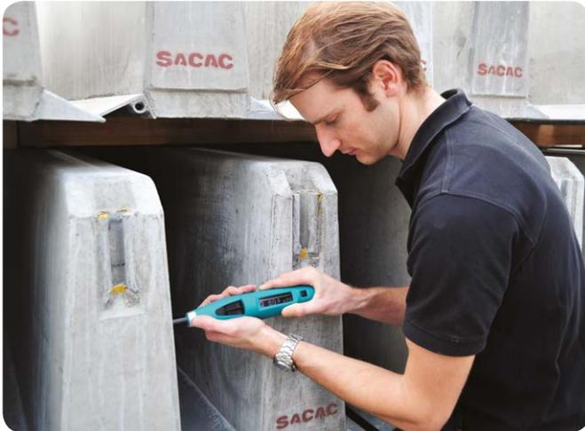
**ST/PC, modelo N/L:** El martillo de rebote más avanzado del mundo, con características de dispersión, durabilidad y rango de medición incomparables.
