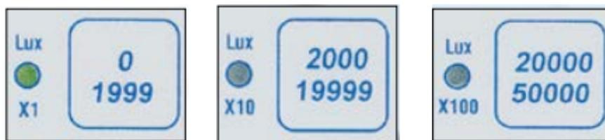
Rango de las teclas Pulse una de las tres teclas de rango para seleccionar la escala apropiada de acuerdo con la intensidad de la luz
