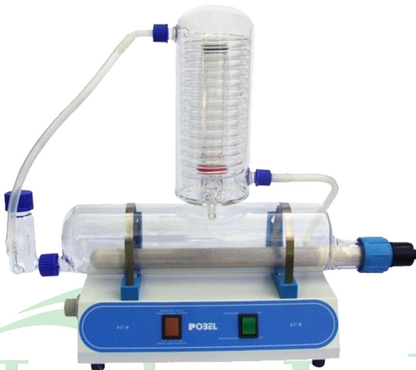
Destilador automático y de producción continua. Alta calidad de destilación con resultado de gran pureza, exento de iones metálicos y sustancias pirógenas. Mecanismo de seguridad que desconecta la resistencia al disminuir la presión del agua de refrigeración, y conecta de nuevo al recuperarse. <sup>®</sup>
