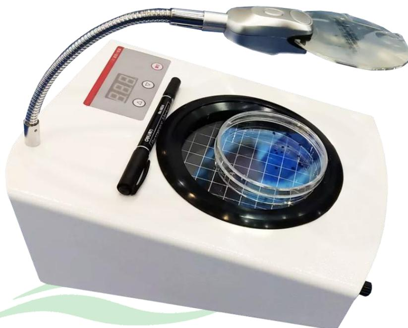
Este instrumento consta de contador, sensor, celda de conteo, etc., diseño que puede proporcionar una comparación de colonias visible, fácil de observar, junto con un bolígrafo especial. Sonará cuando cuente y garantiza la precisión de la prueba, el aumento es variable. Es un instrumento necesario para todos los niveles de salud y estaciones de prevención de epidemias.
