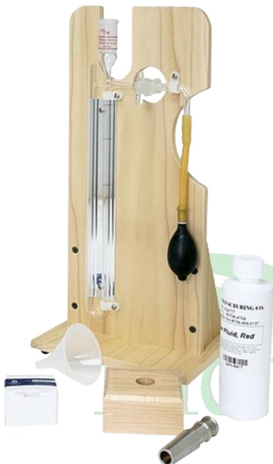
El Aparato de Permeabilidad al Aire Blaine determina la finura del cemento Portland en términos de área superficial específica expresada como la superficie total en centímetros cuadrados por gramo de mortero o cemento.
