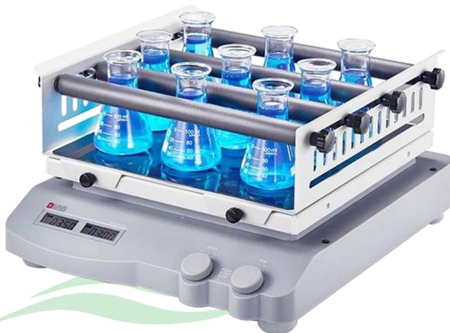
Es un agitador versátil que ofrece una amplia gama de opciones de plataforma para frascos de cultivo, placas petri, matraces Erlenmeyer, botellas y contenedores. Su plataforma tiene una capacidad de 7 kg y tiene pantallas digitales con retroiluminación LCD independientes para la velocidad y la función de temporizador. Incluye software para ser utilizado en el PC y poder documentar y controlar valores. Capacidad: 9 x 250ml o 12 x 100ml. (erlenmeyer).
